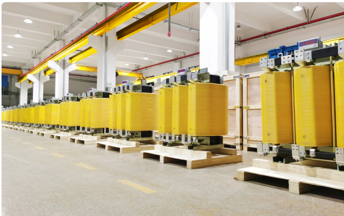
900 kVA transformers, 480V / 415 V, 60 Hz.
